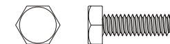
1/4" - 20 X 3/4 HEX HEAD BOLT PERNO DE CABEZA HEXAGONAL DE 1/4 PULG. - 20 X 3/4 PULG. BOULON À TÊTE HEXA 1/4 PO - 20 X 3/4
